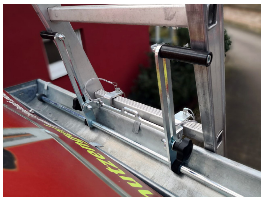
Sécurisation dans la gouttière d'un toit en pente
