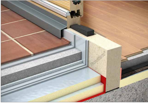
thermische Trennung im Innen- und Aussenbereich, bietet hohe Druckfestigkeit und lässt eine mechanische Befestigung zu
